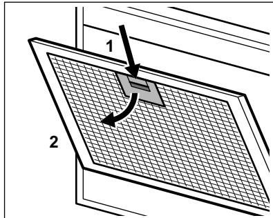
2. Kallutage filtri esiosa kergelt allapoole (2), seejärel tömmake. Korra kahte esimest toimingut kõigi filtrite puhul.
