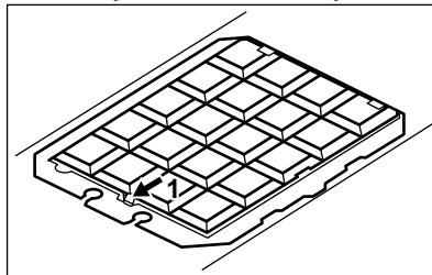
3. Voer dezelfde stappen in omgekeerde volgorde uit om een nieuwe filter te installeren. In ieder geval moeten de filters ten minste om de vier maanden worden vervangen.
