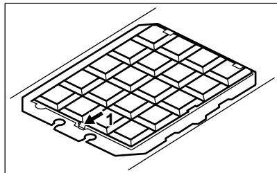
3. Uue filtri paigaldamiseks teostage toiming vastupidises järvikorras. Kindlasti tuleb filtrid välja vahetada vähemalt iga nelja kuu tagant.
