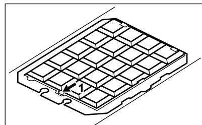
3. Utför proceduren i omvänt ordning när du ska installera ett nytt filter. Under alla omständigheter måste filtren bytas minst var fjärde månad.
