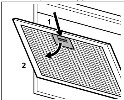
2. Kallista suodattimen etuosaa hiukan alaspäin (2) ja vedä sen jälkeen.
