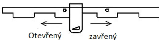
**4.3 Regulace komínového tahu** - provádí se otevřením nebo uzavřením klapky. Pokud klapka neexistuje, na kamna se může napojit kouřovod s klapkou.
