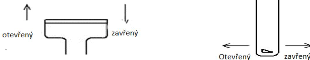
**4.2 Regulace sekundárního vzduchu** - provádí se pomocí mechanismu úplným otevřením nebo uzavřením otvoru pro vzduch, který je dodáván nad dvířky. Schéma 2 ukazuje různé typy mechanismů:
