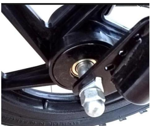
Ujistěte se, že podložky zapadly do svých otvorů a distanční elementy mezi vidlicí a kolem jsou korektně umístěny. / Uistite sa, že podložky zapadli do svojich otvorov a dištančné elementy medzi vidlicou a okolo sú korektnie umiestnené.
